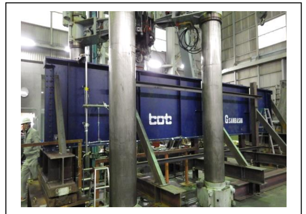
▼2014年度G栈橋 载荷実験の様子
